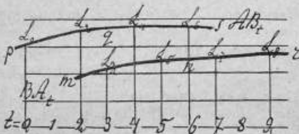
Рис. 2. Абсциссы—времени, ординаты — положенія равновѣсій при взвѣшиваніяхъ АВ и ВА. Площадь напр. L_2 , L_6 и m , дѣленная на разность абсциссъ даетъ среднюю разность ординатъ.
