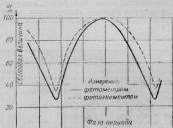
Рис. 6. Изменение световой величины у «белой» люминесцентной лампы за период по измерениям различными способами.
