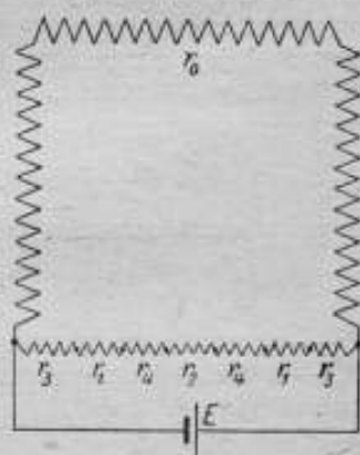
Рис. 4. Электрическая схема, эквивалентная магнитной цепи
