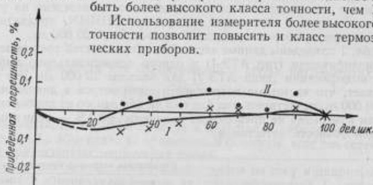
Рис. 8. Кривые приведенных погрешностей градуировки шкал термоэлектрических приборов.
