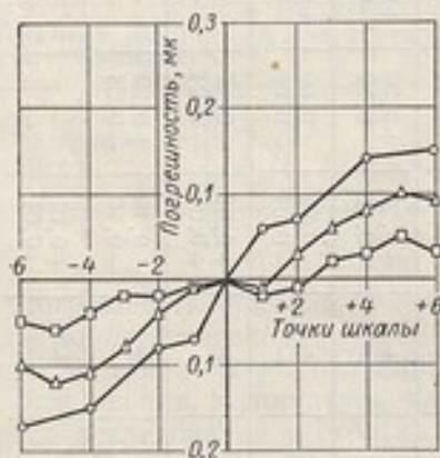
Рис. 5. Кривые погрешностей показаний микрокатора № 846 при поверке по концевым мерам и на приборе ПКМ:
