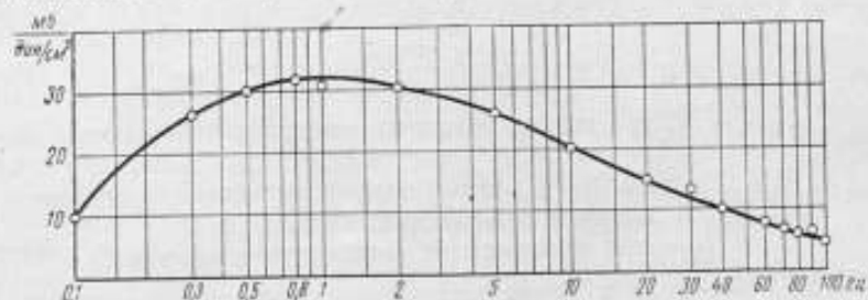
Рис. 5. Частотная характеристика тракта компенсации
