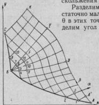
Рис. 1. Семейство линий скольжения у контура деформированной модели.
