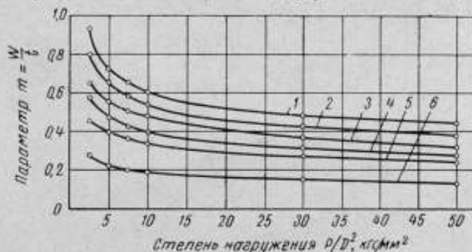
Рис. 2. Зависимость изменения безразмерного параметра m от степени нагружения:
