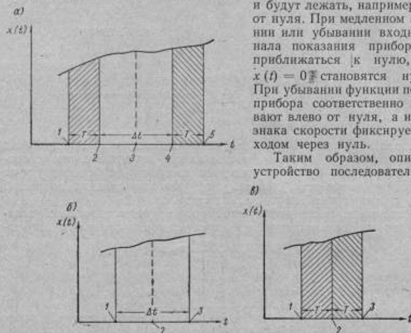
Рис. 2. К пояснению работы дискретных дифференциаторов:
