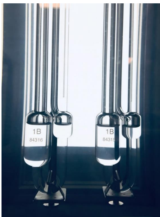
Рисунок 3.17 – Полиальфаолефиновое масло, помещённые в капиллярном стеклянном вискозиметре в термостатическую ванну при температуре минус 30 °С
