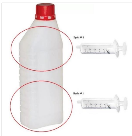
Рисунок 3.8 – Схема отбора представительной пробы
