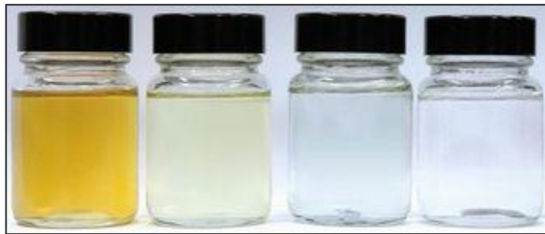
Рисунок 3.2 – Общий вид базовых масел четырёх групп, расфасованных в прозрачные флаконы. (Слева – направо I, II, III и IV группы)
