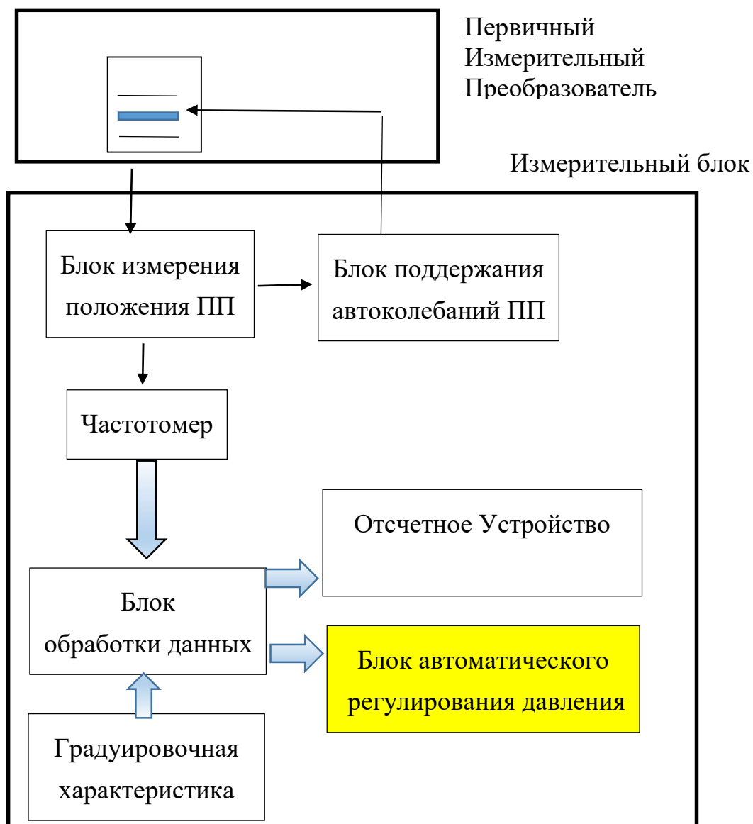
Рисунок 2.16 – Структурная схема деформационно-частотного вакуумметра
