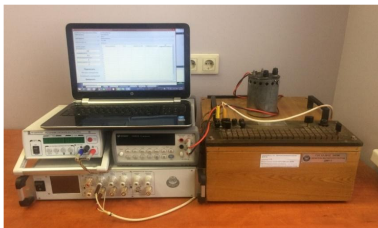
Рисунок 4.13 – Фотография измерительного комплекса для определения калибровочных коэффициентов USB-флюксметра
