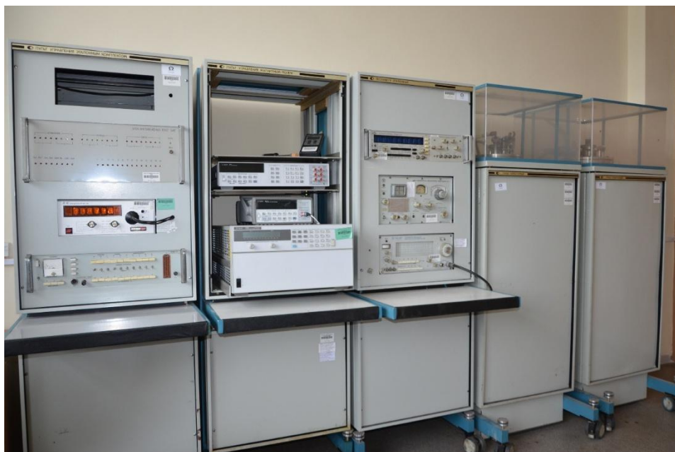
Рисунок 1.5 – Фотография государственного первичного специального эталона единицы магнитной индукции в диапазоне 1-10Тл – ГЭТ 82-85
