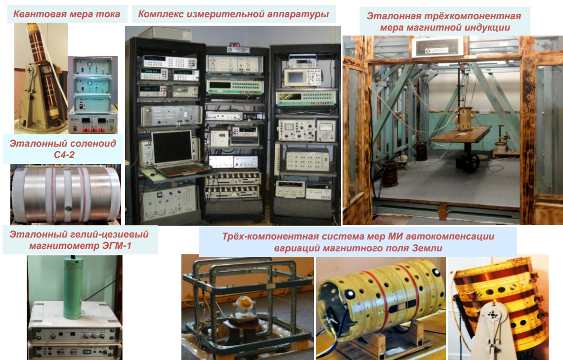
Рисунок 1.3 – Фотография основных частей эталонного измерительного комплекса для воспроизведения и передачи единицы магнитной индукции постоянного поля
