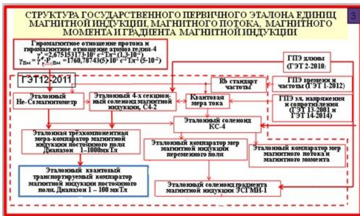
Рисунок 1.2 – Структура государственного первичного эталона единиц магнитной индукции, магнитного потока, магнитного момента и градиента магнитной индукции ГЭТ12-2011
