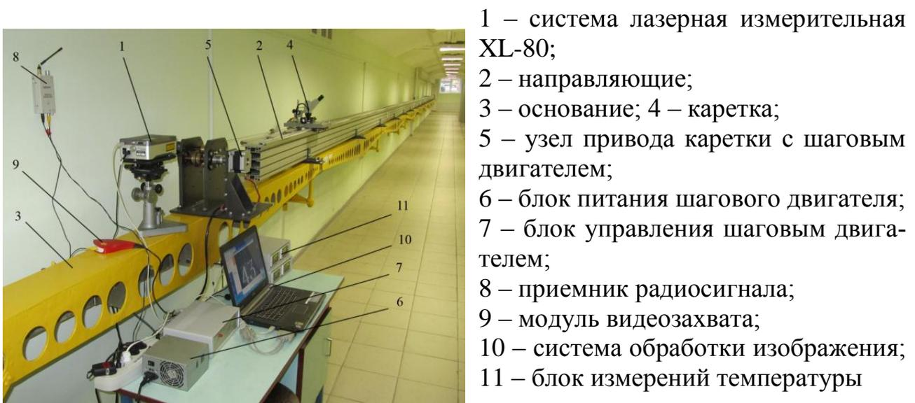
Рис. 1. Внешний вид компаратора
