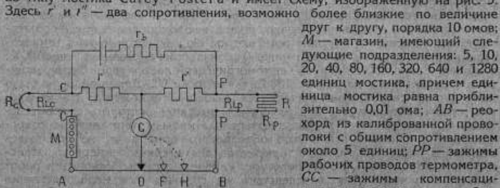
Рис. 5. Схема мостика Callendar'a.
