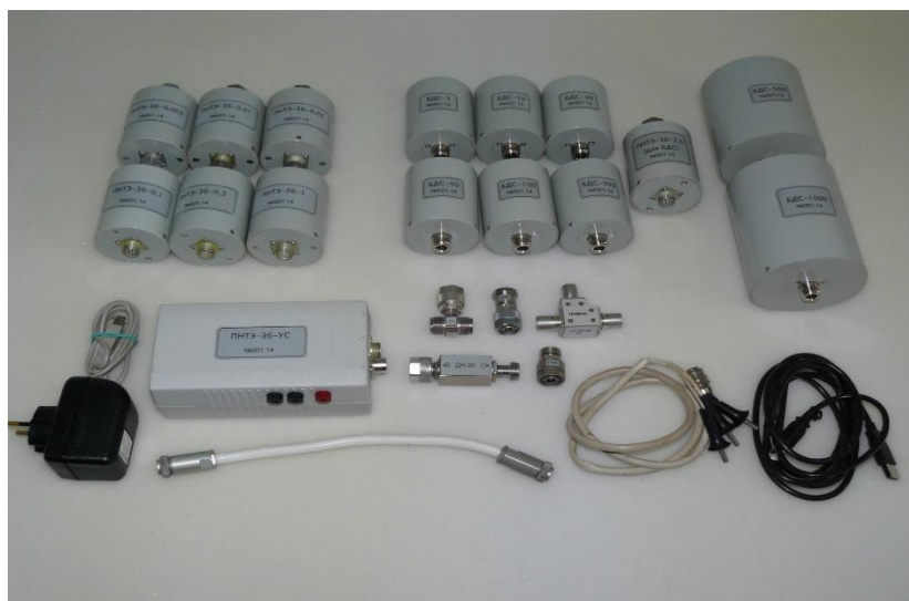
Рисунок 8. Внешний вид модулей и блоков комплекта ПНТЭ-36
