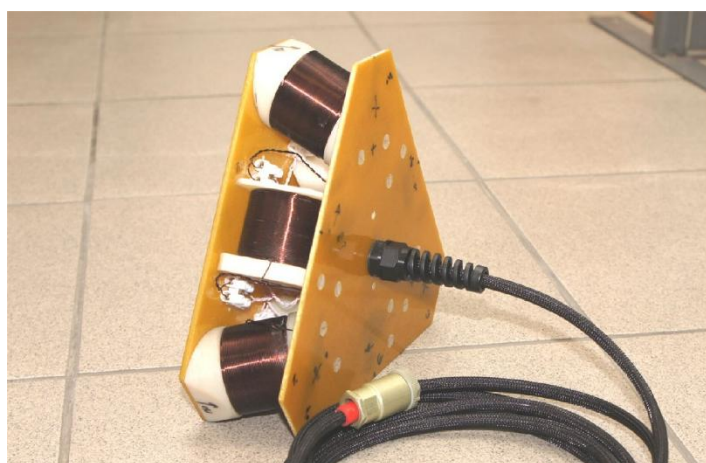
Рисунок 5. Вид многокомпонентного излучателя. Справа приведено положение рабочей зоны относительно излучателя.
