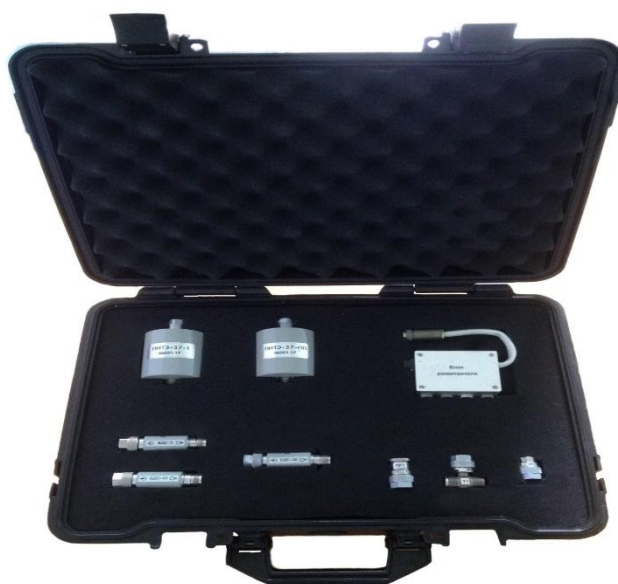
Рисунок 9. Внешний вид модулей и блоков комплекта ПНТЭ-37 в укладочном кейсе
