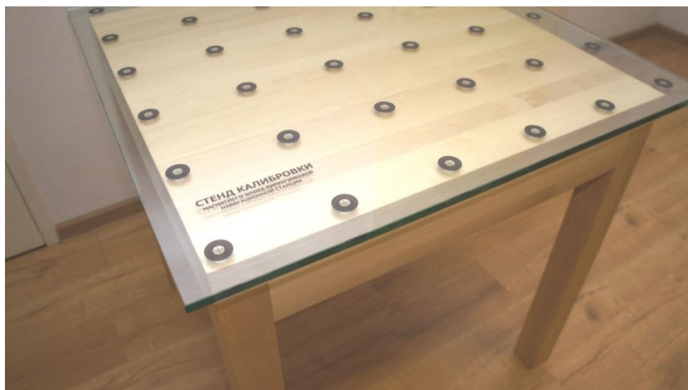
Рисунок 4. Калибровочный стенд с нанесенными метками опорных точек.
