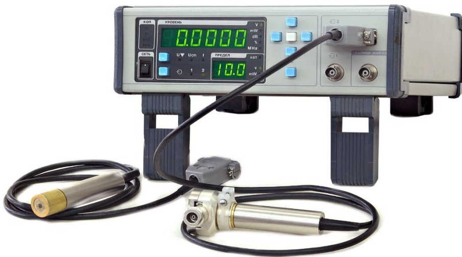
Рисунок 10. Внешний вид вольтметра универсального В7-83, снабженного пробниками П1 и П2.
