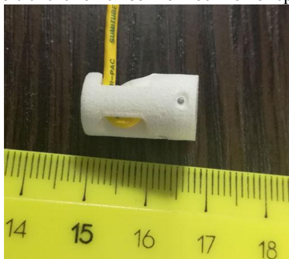
Рисунок 2. Трёхкомпонентный датчик, закрепляемый на хирургическом инструменте. Длина датчика – 18 мм, диаметр – 10 мм.
