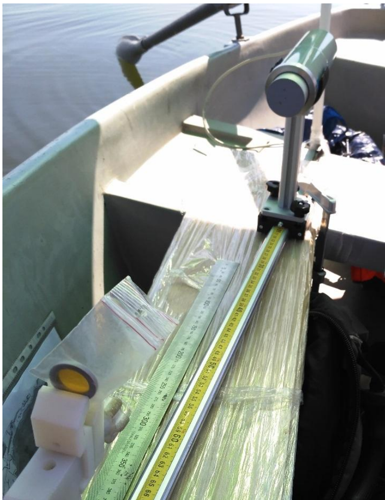
Рисунок 2. Измерение мощности кермы в воздухе от источника гамма-излучения ^{137}\text{Cs} на лодке с использованием блока-компаратора БКМГ-АТ1102 на Заславском водохранилище
