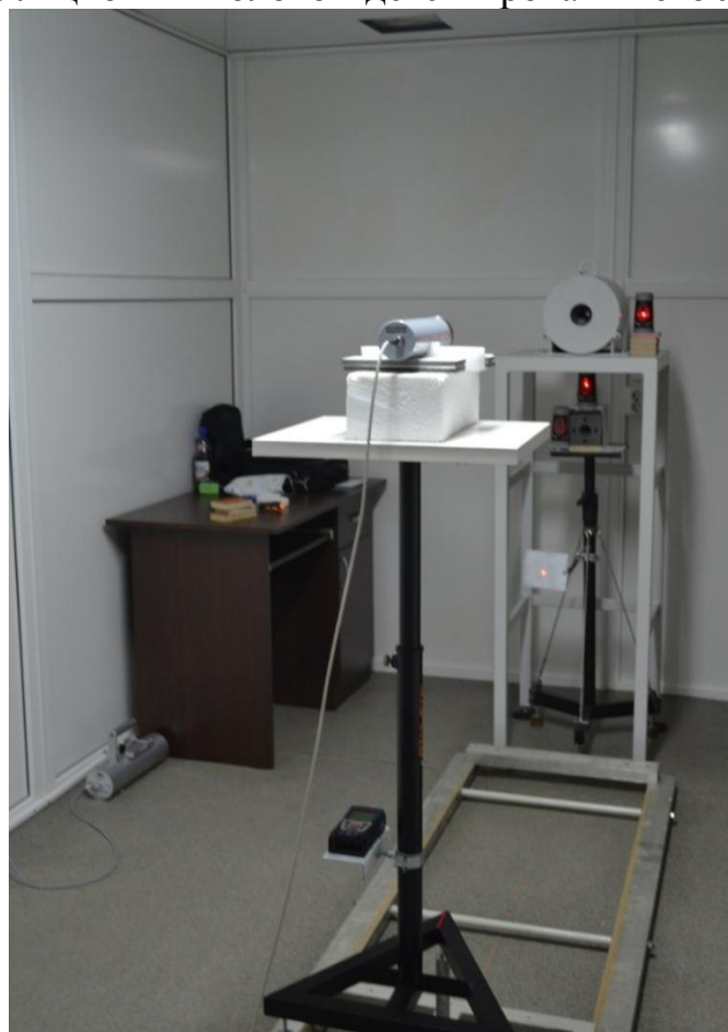
Рисунок 7. Измерение МАЭД на калибровочном стенде с источником гамма-излучения ^{137}\text{Cs} с использованием блока-компаратора
