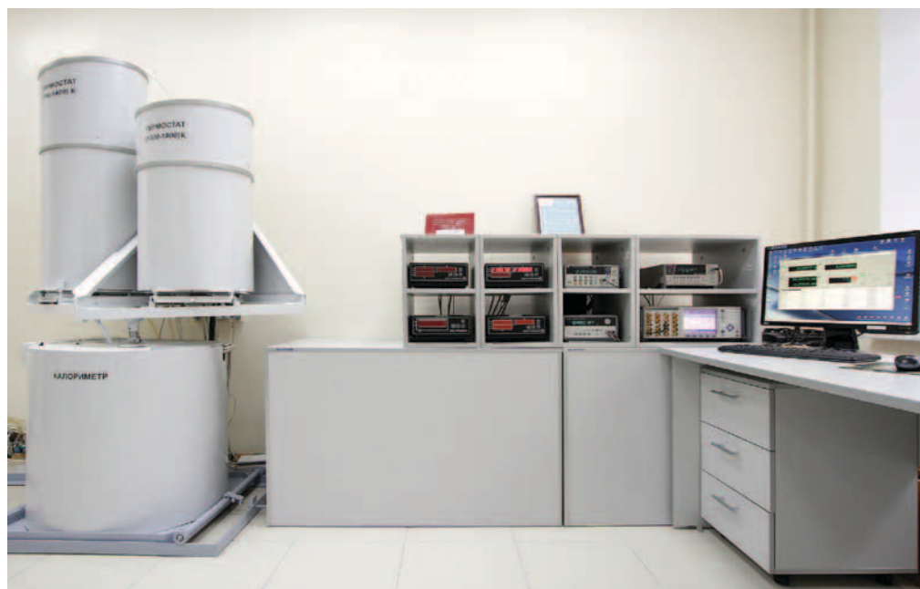
Государственный первичный специальный эталон единиц удельной энтальпии и удельной теплоемкости твердых тел в диапазоне температур от 700 до 1800 °К
