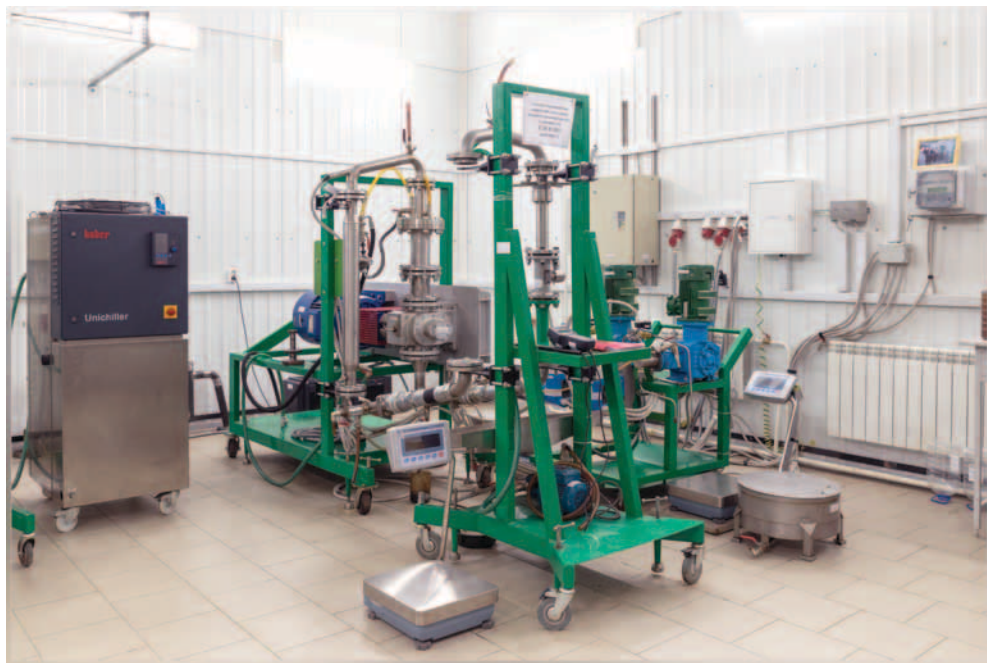
Государственный первичный специальный эталон единицы объемного влаго содержания нефти и нефтепродуктов ГЭТ 87-2011
