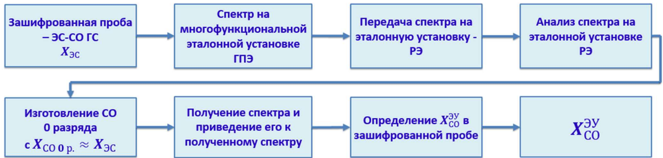
Рисунок 9 – Аттестация РЭ на основе ИК-Фурье спектрометра с применением цифровой спектральной модели ЭС - СО ГС для выпуска СО ГС 1-го разряда
