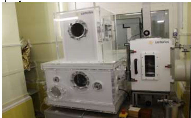
Рисунок 4 – Вакуумный компаратор CCL 1007 с вакуумной транспортной системой VTS
