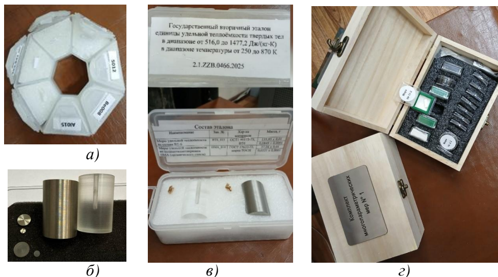
Рисунок 5 – Внешний вид мер для передачи единицы удельной теплоемкости твёрдых тел: а) – ГВЭТ 60-2-2026, б) – ГВЭТ 60-4-2025, в) - ГВЭТ 60-3-2024, г) - ГВЭТ 60-5-2026
