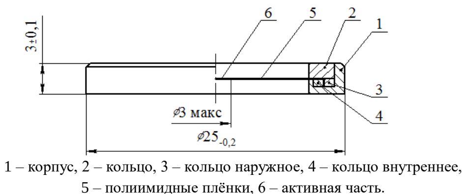
Рисунок 5 – Конструкция радионуклидного источника ОСГИ-РТ
