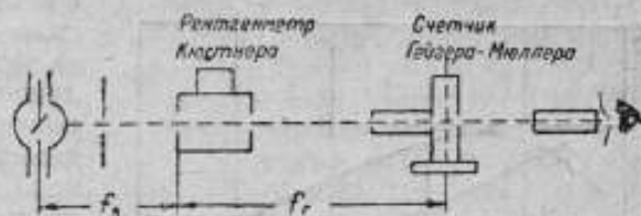
Рис. 5. Общая схема расположения измерительной аппаратуры при работе с рентгеновскими лучами.
