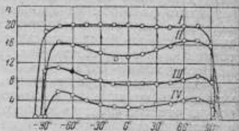
Рис. 3. Зависимость показаний гальванометра от угла поворота фотоэлемента внутри кожуха для различных полей освещения. Кривая I — поле освещения больше размеров окна камеры; кривая II — поле 22 \times 13 мм 2 ; кривая III — круг диаметром d=13 мм; кривая IV — круг d=8 мм.
