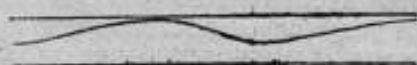
Рис. 7. Осциллограмма тока в шаровой камере при направлении поля в камере от внешней обкладки к внутренней. Полуволновое, синусоидально изменяющееся напряжение.
