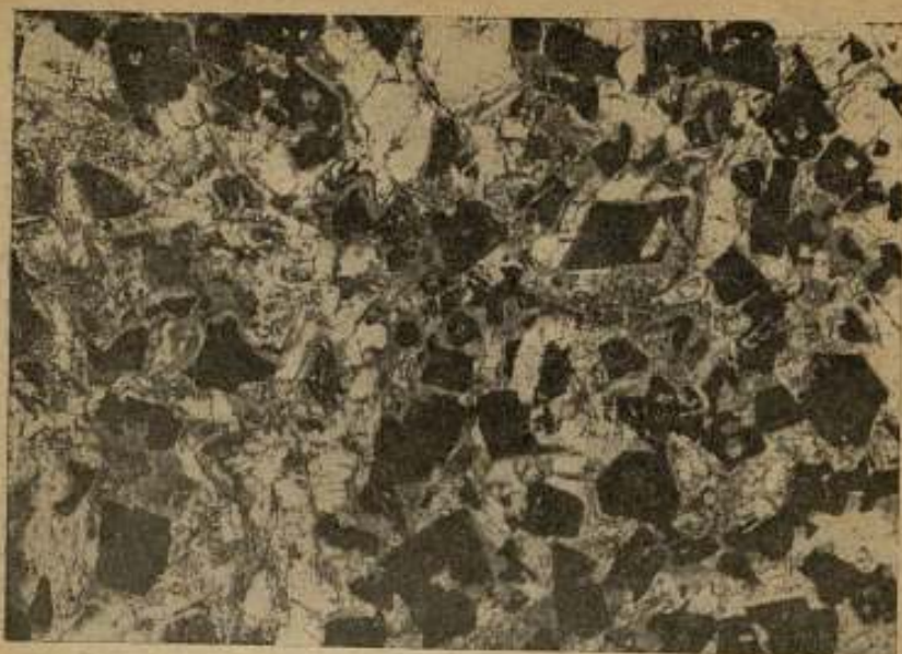
Рис. 2. Николи \square \times 12 . Диабаз рудный, крупнозернистый, № 1/10. Белые зерна — плагиоклаз; серые — роговая обманка, пироксен, биотит; черные — магнетит.
