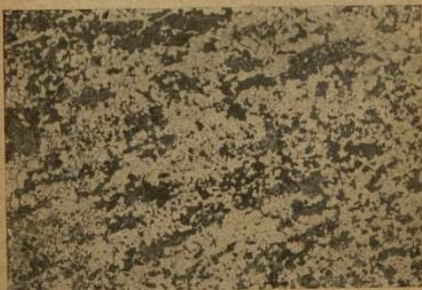
Рис. 9. Николи \parallel \times 12 . Кварц-амфиболо-магнетитовый сланец, № 39/31. Белые зерна — кварц; серые — амфибол; черные — магнетит.
