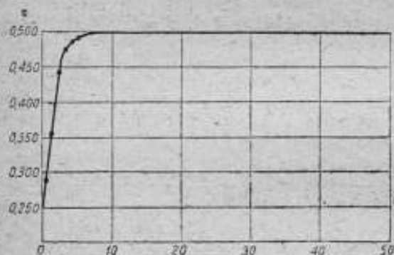
Рис. 4. Зависимость чувствительности магнитометра от длины вертикальных магнитов.
