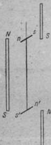
Рис. 7. Схема расположения стержней перемаллой магнитно-З-вариометра.
