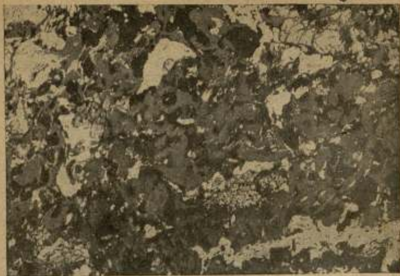
Рис. 10. Николи \parallel \times 12 . Кварц-амфиболо-магнетитовый сланец, № 17. Белые зерна — кварц; серые — амфибол; черные — магнетит.
