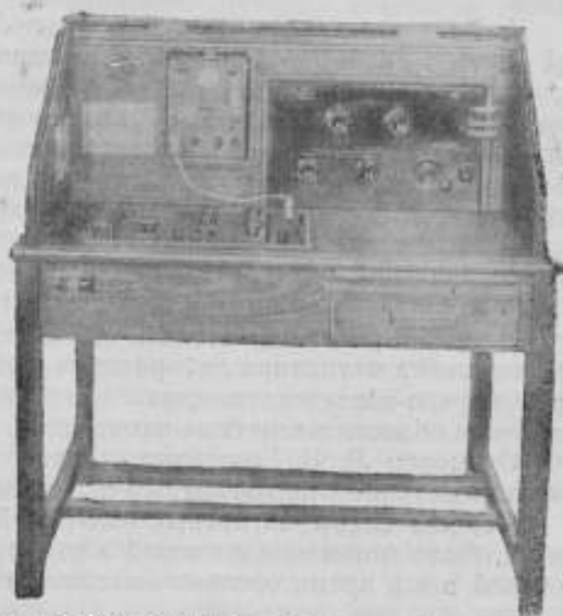
Рис. 16. Установка для поверки трансформатора тока при повышенных частотах (50 + 8000 гц) до 200 а.
