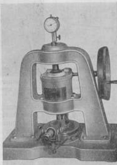
Рис. 4. Пресс для нанесения ламнограммы.
