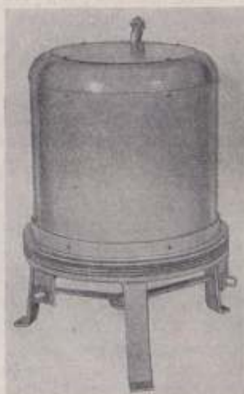
Рис. 7. Внешний вид емкостной разделительной камеры в термостатном кожухе.
