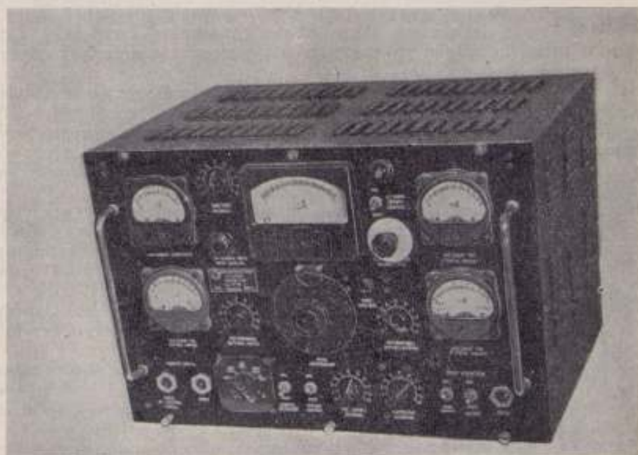
Рис. 10. Внешний вид фазочувствительного индикатора ранновесия моста (ФЧИ).
