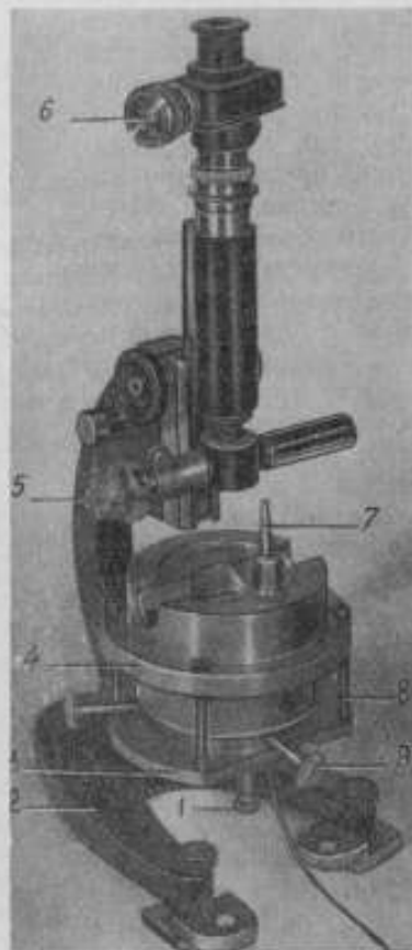
Рис. 4. Оптическое устройство разделительной камеры.
