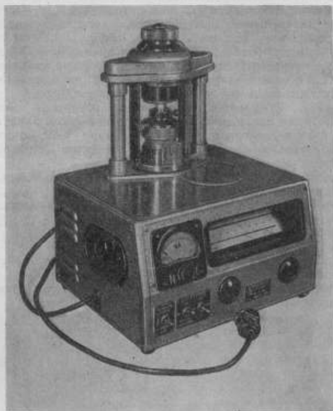
Рис. 7. Прибор типа А-24 для измерения теплопроводности.
