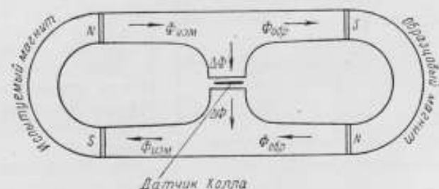
Рис. 5. Дифференциальная схема по магнитному потоку.
