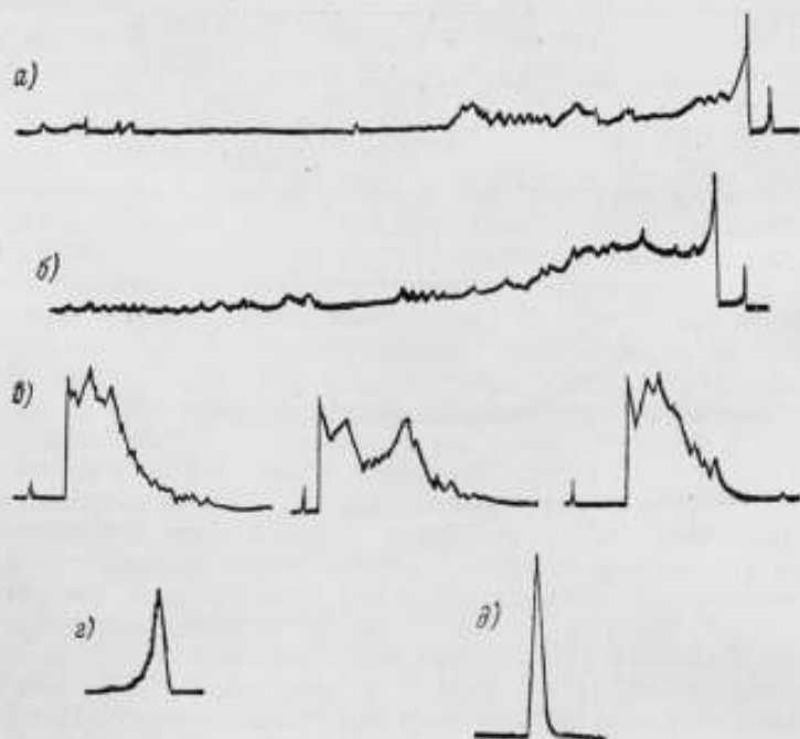
Рис. 4. Баллистические импульсы сплава 65НП (0,02 мм) при: а — H = 0,06 э; \mu = 3500 эс/э; t = 2,8 сек; n = 500 вит.; б — H = 0,065 э; \mu = 8500 эс/э; t = 3 сек (5 сек); n = 500 вит.; в — H = 0,0755 э; \mu = 134\,000 эс/э; t = 1,8 сек; n = 150 вит.; г — H = 0,0905 э; \mu = 131\,000 эс/э; t < 0,5 сек; n = 25 вит.; д — H = 0,1 э; \mu = 122\,000 эс/э; t < 0,5 сек; n = 25 вит.
