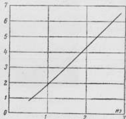
Рис. 11. Зависимость \frac{1}{\tau} от напряженности магнитного поля для сердечника размерами d_{ср} = 5,4 мм и h = 10 мм из сплава 79НМ с толщиной ленты 3 мк.
