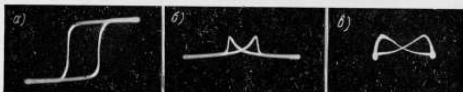
Рис. 12. Петля гистерезиса пленочного элемента при наличии постоянного поперечного магнитного поля: а — продольная петля; б — поперечная петля; в — годограф магнитного момента.
