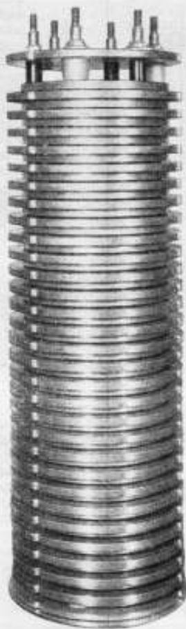
Рис. 8. Внутреннее устройство квантометра типа УК-50/2
