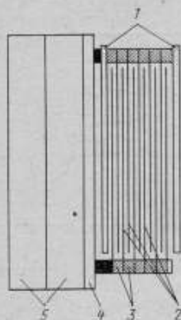
Рис. 1. Схема ионизационной камеры для измерения потока энергии фотонного излучения
