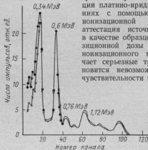
Аппаратурные спектры \gamma -излучения источников ^{226}\text{Ra} , помещенных в платино-иридиевый (1) и стальной (2) футляры
