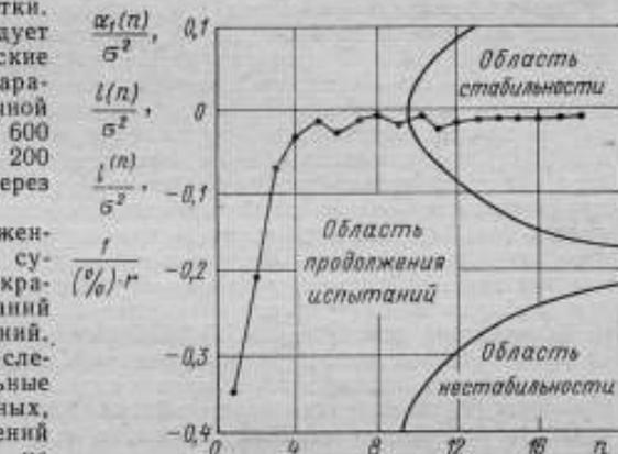
Рис. 2. Выход процесса  $\alpha_1(n)$  из области продолжения испытаний в область стабильности
