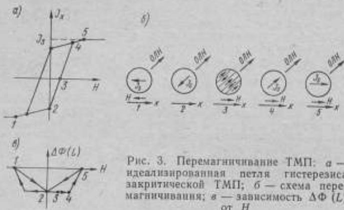
Рис. 3. Перемагничивание ТМП: а — идеализированная петля гистерезиса закритической ТМП; б — схема перемагничивания; в — зависимость  $\Delta\Phi(L)$  от  $H$
