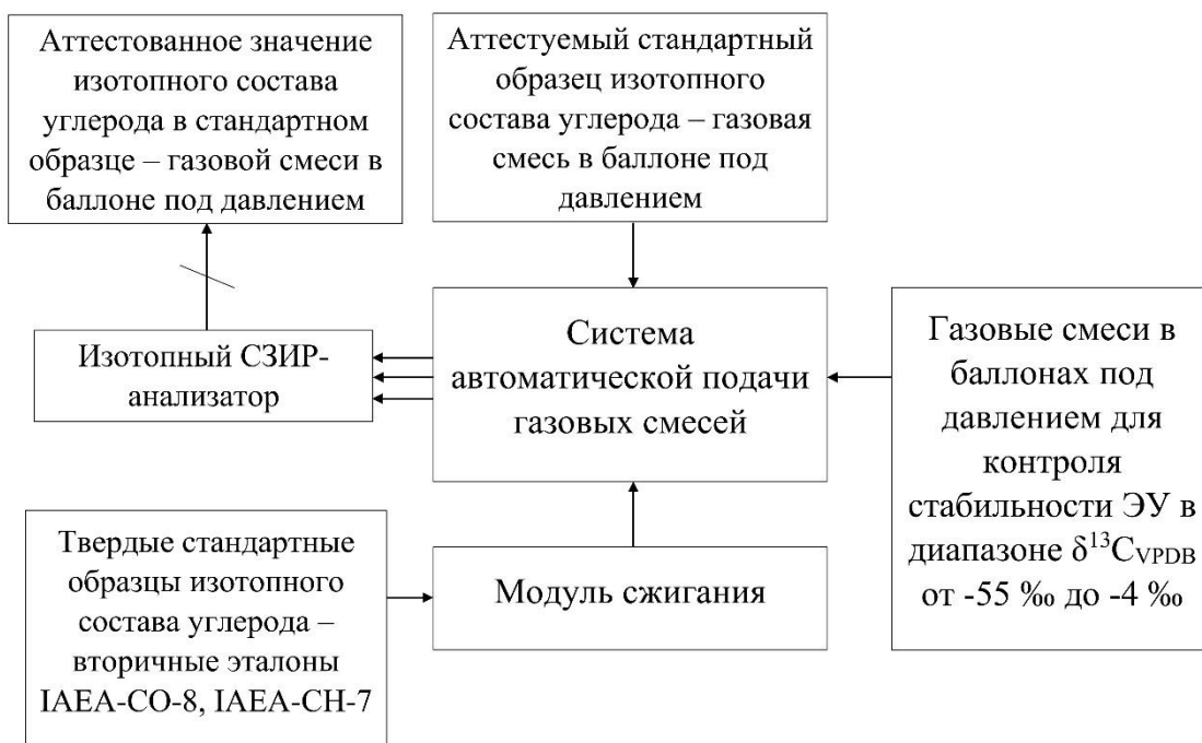
Рисунок 1. Разработанная схема ЭУ для аттестации стандартных образцов изотопного состава углерода – газовых смесей в баллонах под давлением.
