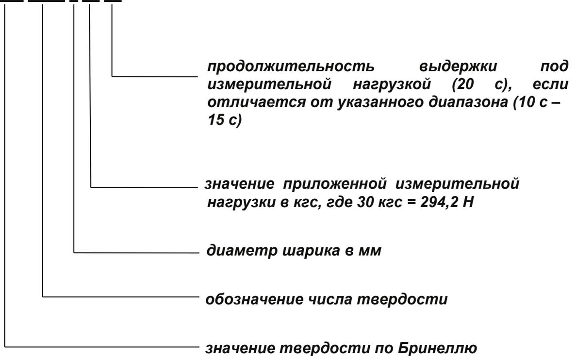
Примечание — символ W в обозначении числа твердости указывает на то, что измерения проводились с использованием твердосплавного наконечника. Если измерения твердости проводятся с использованием стального наконечника, то символ W в обозначении числа твердости не приводится.
