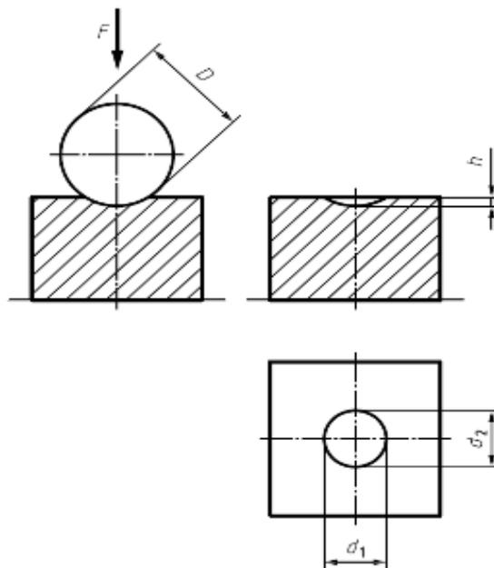
Рисунок 1 — Принцип измерений
