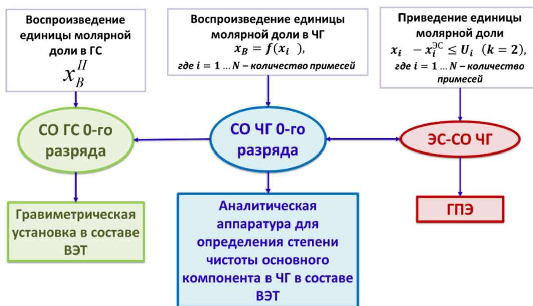
Рисунок 3.2 – Алгоритм воспроизведения единицы молярной доли компонентов в СО ГС 0-го разряда
