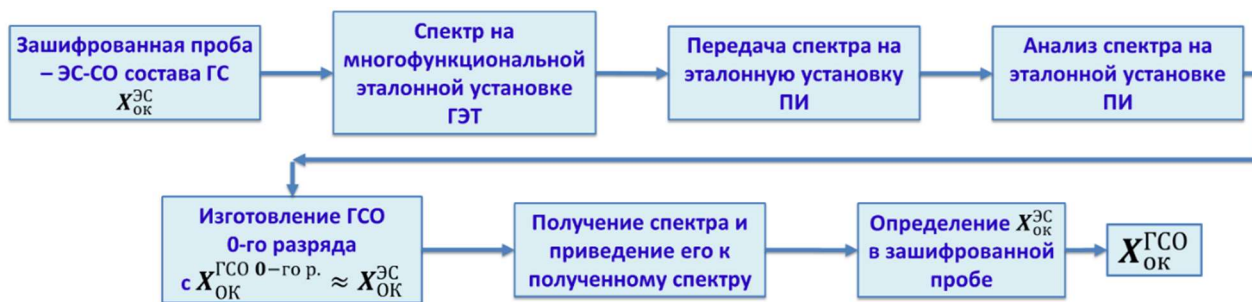
Рисунок 3.4 – Аттестация РЭ на основе ИК-Фурье спектрометра с применением цифровой спектральной модели ЭС - СО ГС для выпуска СО ГС 1-го разряда.
