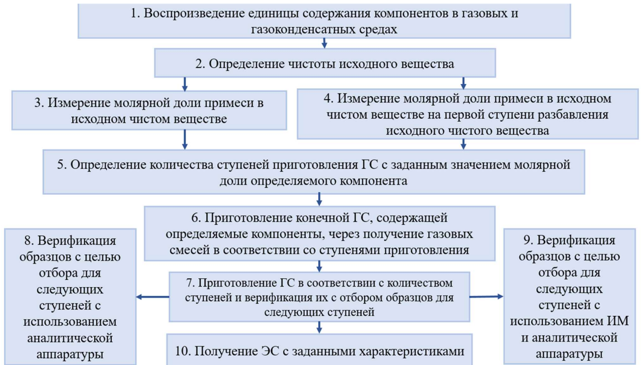
Рисунок 2.1 – Структурно-операционная схема воспроизведения единиц содержания компонентов в газовых и газоконденсатных средах
