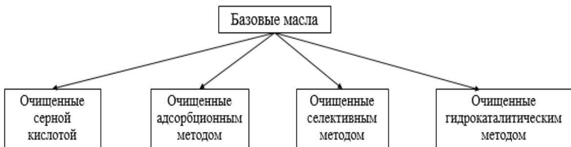
Рисунок 3.3 – Классификация базовых масел по способу очистки [95]
