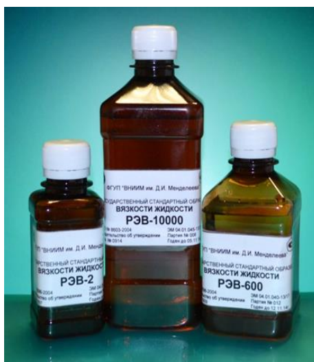
Рисунок 1.12 – Общий вид стандартных образцов вязкости жидкости, упакованных в тёмные полимерные флаконы
