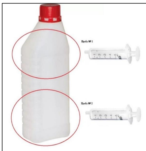
Рисунок 3.8 – Схема отбора представительной пробы
