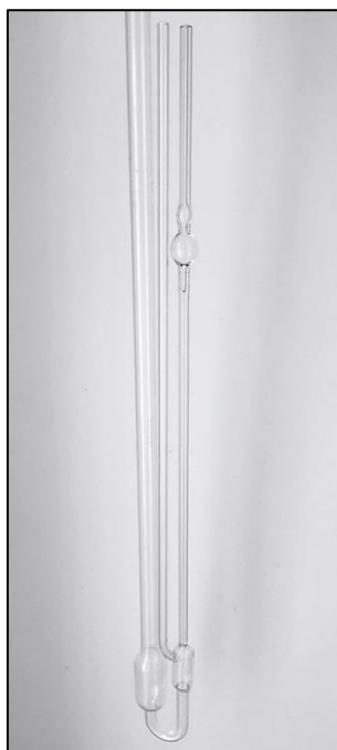
Рисунок 1.9 – Общий вид стеклянного капиллярного вискозиметра, входящего в состав рабочего эталона единицы кинематической вязкости жидкости первого разряда
