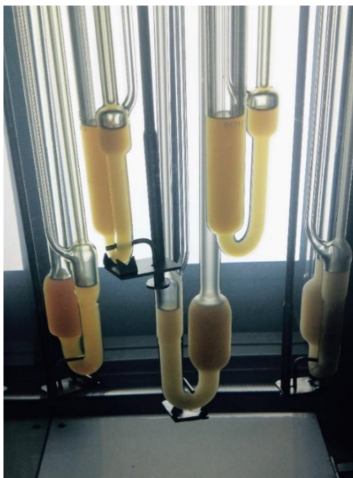
Рисунок 3.16 – Моторные масла, помещённые в капиллярном стеклянном вискозиметре в термостатическую ванну при температуре T = -30\text{ }^{\circ}\text{C}
