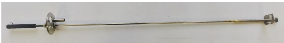
Рисунок 2.7 – Внешний вид устройства для установки вискозиметров
