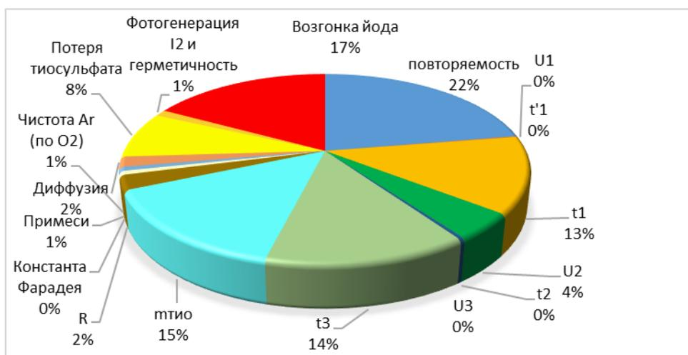
Рисунок 21 – Вклады составляющих бюджета неопределённости при измерении содержания тиосульфат-ионов в растворе тиосульфата натрия
