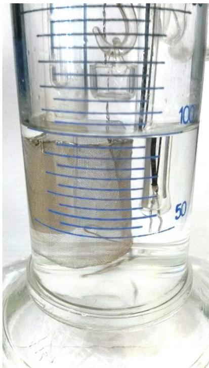
Рисунок 8 – Внешний вид кулонометрической ячейки
