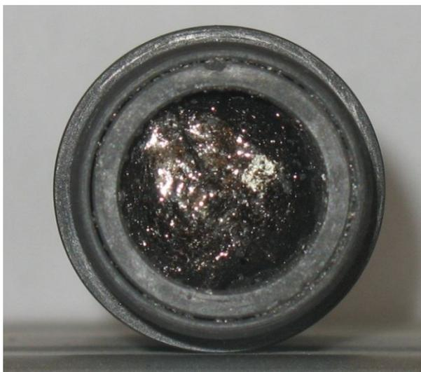
Рисунок 21 - Изображение ВТРТ Pt-C без крышки
