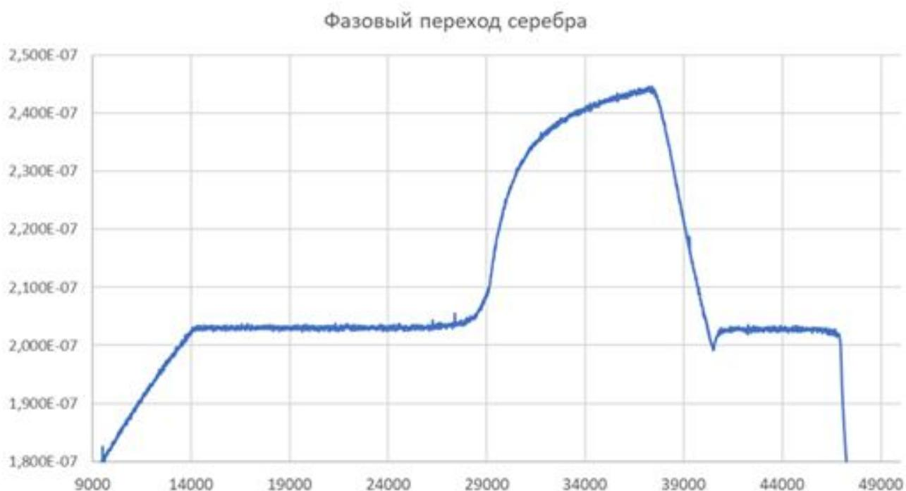
Рисунок 50 - Фазовый переход реперной точки серебра
