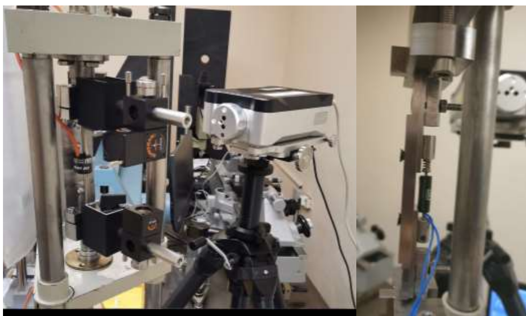
Рисунок 5.8 – Косвенные измерения с помощью интерферометра лазерного
