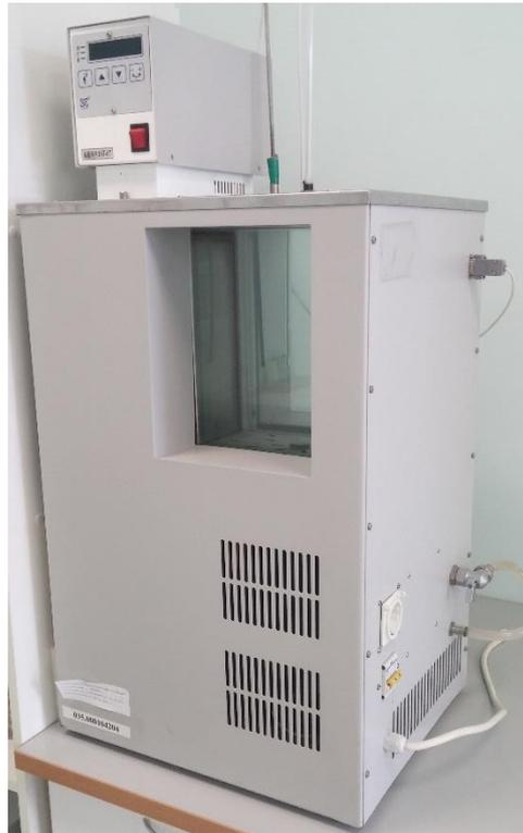
Рисунок 31 –Термостат жидкостной
