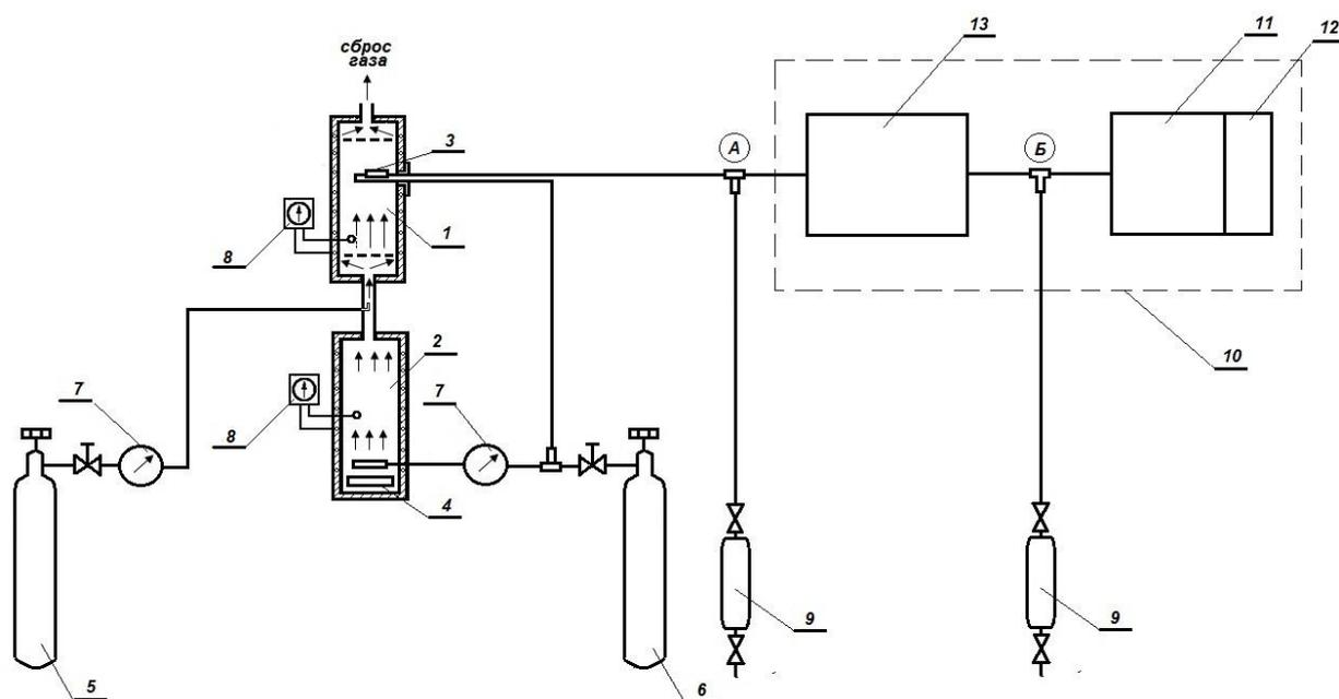
1 – камера - смеситель тестовой газовой смеси; 2 - камера - увлажнитель газа-носителя; 3 – пробоотборник - разбавитель; 4 – емкость с водой; 5 - баллон с газовой смесью ПГС-ГСО; 6 – баллон с газом - носителем (азот, воздух); 9 – пробоотборники; 10 – АИС; 11 – блок газоанализаторов; 12 – блок ИВК с системой обработки, хранения, визуализации и передачи данных; 13 – система отбора, транспортировки и подготовки проб.
