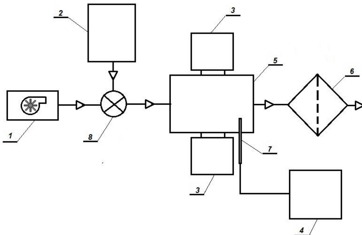
1 – вентилятор; 2 - генератор аэрозоля; 3 – испытуемый оптический анализатор пыли (передатчик и приемник); 4 – рабочий эталон массовой концентрации аэрозоля; 5 - камера испытательная динамическая; 6 -воздушный фильтр; 7 - пробоотборная трубка динамической камеры; 8 - смесительная камера.
