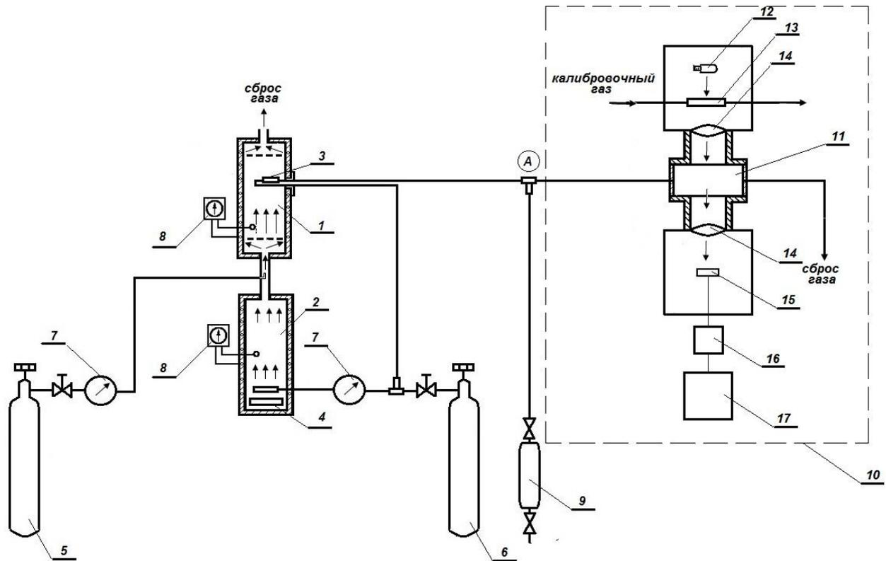
1 – камера - смеситель тестовой газовой смеси; 2 – камера - увлажнитель газа - носителя; 3 – пробоотборник - разбавитель; 4 – емкость с водой; 5 - баллон с газовой смесью ПГС-ГСО; 6 – баллон с газом - носителем (азот, воздух); 9 – пробоотборники; 10 – АИС; 11 – камера с тестовой газовой смесью; 12 – источник излучения; 13 - внутренняя калибровочная ячейка; 14 - защитное окно; 15 – детектор; 16 – электронный модуль; 17 - блок регистрации, хранения, визуализации и передачи данных.
