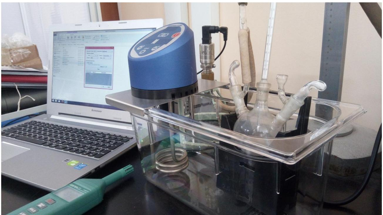
Рисунок 2.6 - Внешний вид эталона для области измерений давления насыщенных паров жидкости
