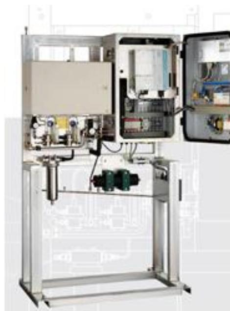
Рисунок 1.7 - Внешний вид анализатора RVP-4
