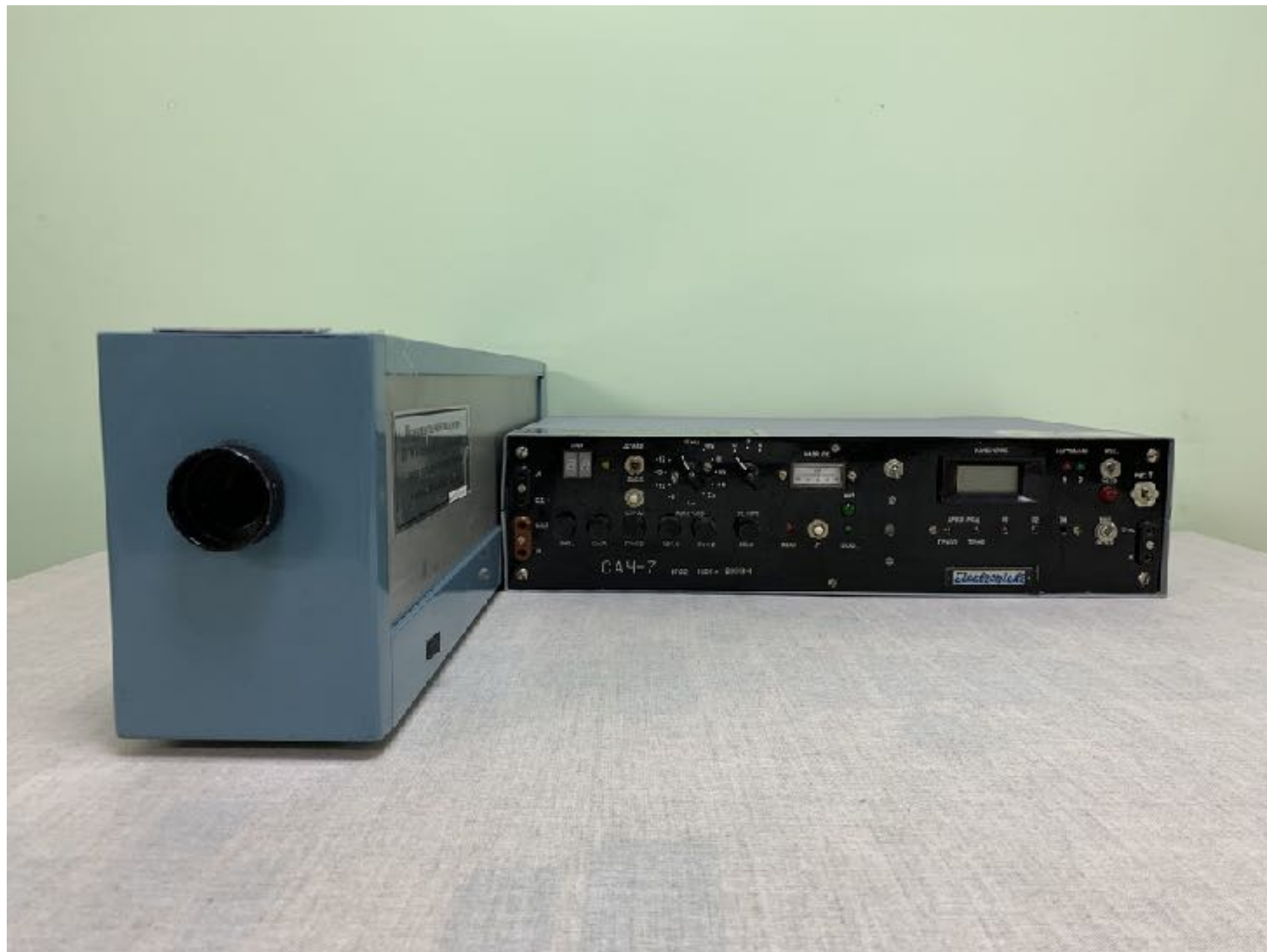
He-Ne/I 2 лазер, стабилизированный по линии насыщенного поглощения в молекулярном йоде 127
