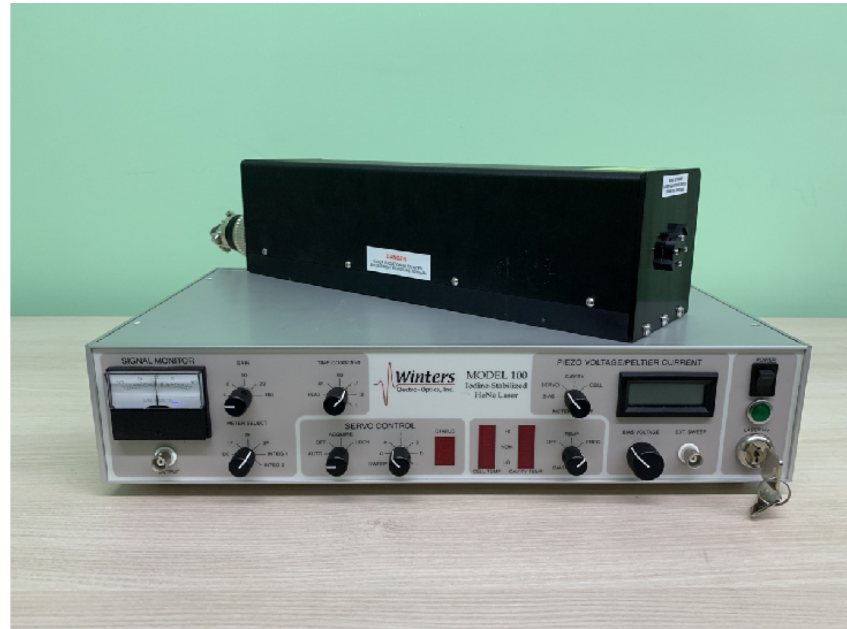
He-Ne/I 2 транспортируемый лазер, стабилизированный по линии насыщенного поглощения в молекулярном йоде 127
