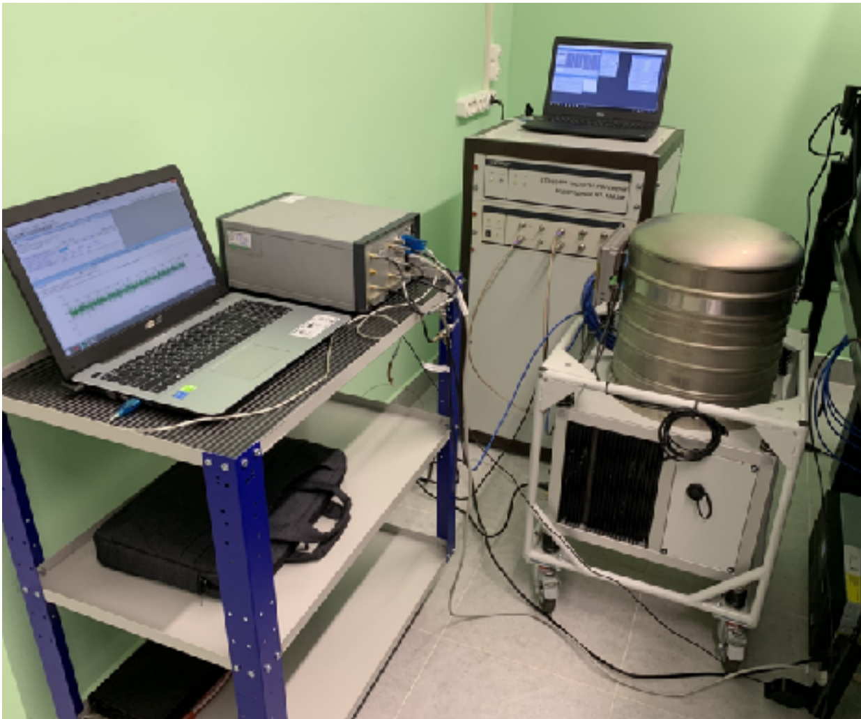
Поверка стандарта частоты и времени водородного Ч1-1003М
