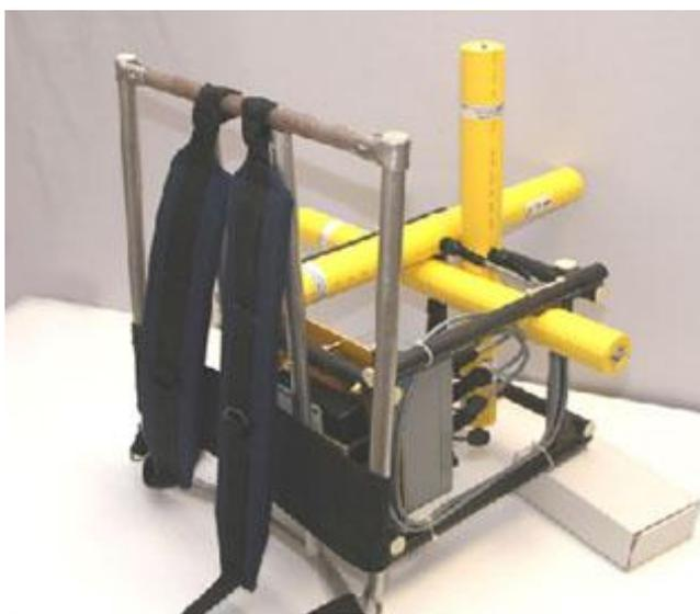
Рисунок 1. Магнитометр «КБД», используемый для внутрубной диагностики подземных трубопроводов.
