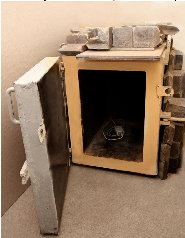
Рисунок 3. Общий вид низкофоновой камеры
