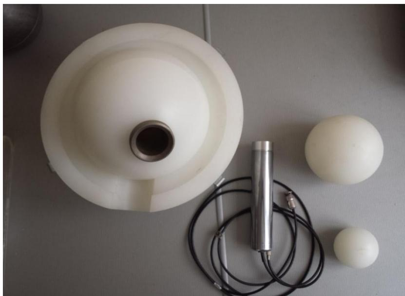
Рисунок 1. Блок детектирования из состава ГЭТ 117-2010.
