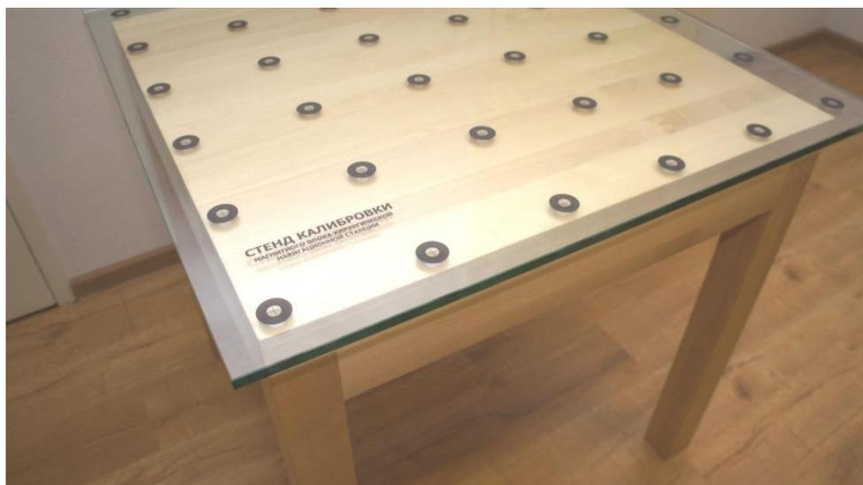
Рисунок 4. Калибровочный стенд с нанесенными метками опорных точек.
